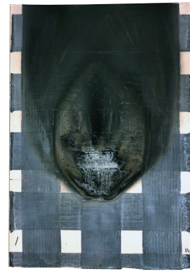
▲延焼性試験後の試験体
