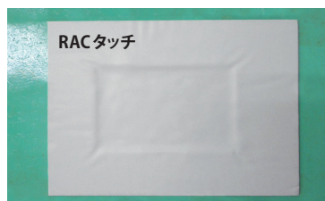
▲RACタッチに膨れやはがれなどの変状は発生しない。
