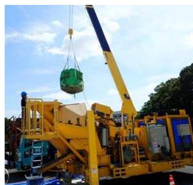
図-3 ベースパックの練混ぜに使用可能なミキサの一例
