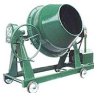
図-2 ミニパックの練混ぜに使用可能なミキサの一例
