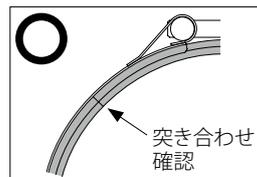
・Cタイプ/350A～600Aはヒンジ構造ではないため、ケーシングの開閉がしづらくなっており、『荷締めベルト』をご利用下さい。また、詳しい使用方法は『荷締めベルト』の取扱説明書をご参照下さい。
