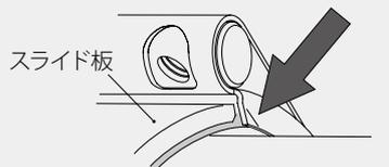
・ボルトをナット穴に通し、ネジ2～3山分回してケーシングが開かないように仮止めしておきます。
