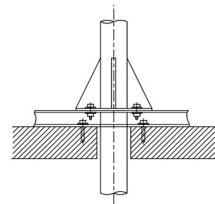
**施工例：**立て管から横引き管を分岐する場合は、立て管の熱伸縮を吸収させる為、図のようにフレキシブル継手を配置します。また、フレキシブル継手の近隣には振れ止め支持を設置します。
