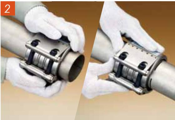
片側のパイプに本継手を通した後、もう一方のパイプを設置したら、本継手をマーキングした位置まで移動します。
