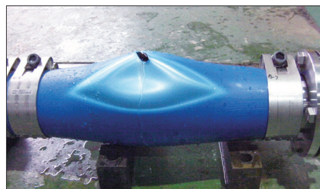
破壊水圧試験
