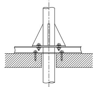
**施工例：**立て管から横引き管を分岐する場合は、立て管の熱伸縮を吸収させる為、図のようにフレキシブル継手を配置します。また、フレキシブル継手の近隣には振れ止め支持を設置します。
