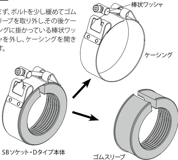
・ケーシングを横移動し、ゴムスリーブの上に配置します。
