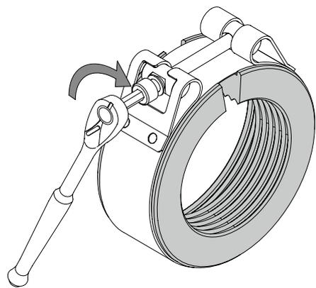
・ラチェットレンチにて、右図のようにケーシングの隙間がなくなるまで締めつければ作業完了です。
