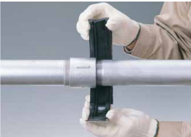
③ 本体を漏れ箇所を巻きつけます(下図参照)。
